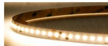
Nur mit stabilisierter 24V Gleichspannung betreiben. LED-Bänder über 5 W pro m unbedingt **auf Metall verkleben** und für Wärmeableitung sorgen.
