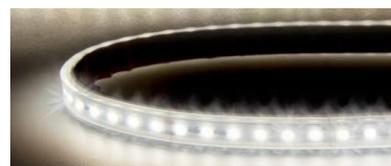
LED-Band/Platine auf Metall zur Wärmeableitung verkleben. Untergrund muß fett- und staubfrei sein.
