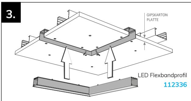
**Schritt 3:** Auf der Rückseite des LED Flexbandprofils pro einem Meter je zwei Montageclips (Art.Nr. **112335**) zur späteren Befestigung im Installationskanal einsetzen und anschließend LED Flexbandprofil in den Installationskanal drücken. Anmerkung: Achten Sie darauf, dass alle Montageclips einrasten (hören Sie auf das Klickgeräusch).
