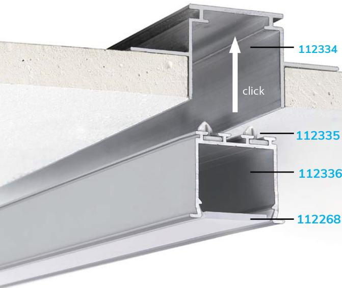
Flächenbündige, rahmenlose Einbaumöglichkeit für Trockenbau- und Gipskartonelemente mit einer Stärke von max. 12,5 mm oder 15 mm. Das Einbauprofil (Art. Nr. [112336](#)) wird mit einem Clip-Mechanismus am Installationskanal (Art.Nr. [112334](#)) befestigt.
