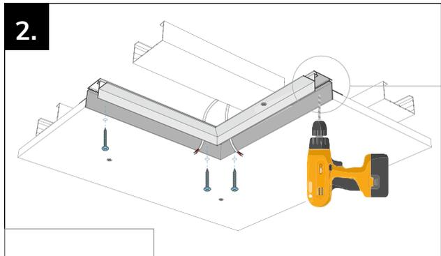
**Schritt 2:** Die Flügel des Installationskanals sowie die Trockenbau- bzw. Gipskartonelemente mit einem Bohrer vorbohren und anschließend fest miteinander verschrauben.
