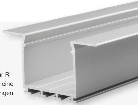
**Kühlmasse: 307 g/m** | Das WING20 mit seitlichem, geraden Flansch kann mit Installationskanälen für Rigips-Platten mit 12,5 mm und 15 mm kombiniert verbaut werden. Hochwertige Verbindter ermöglichen eine professionelle Montage von komplexen Lichtlösungen mit LED Lichtleisten. Flache und hohe Abdeckungen verfügbar; ausgezeichnete Wärmeableitung!
