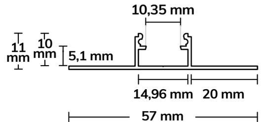
Das Schutzcover wird nach der Montage des Profils in das Alu-Profil zum Schutz eingeklickt. Dadurch, dass es sehr robust ist, hält es dem Druck beim Verspachteln/-putzen oder Streichen stand. Es verhindert, dass Spachtelmasse, Kleber, Dichtmaterial, Silikon oder Farbe in den Innenraum eindringt. Danach wird das Schutzcover abgenommen, gereinigt und ist vielfach wiederverwendbar. Abschließend kann die Abdeckung (PC) in das Profil eingesetzt werden.
