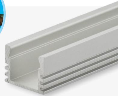
**Kühlmasse: 133 g/m** | Das Montageprofil MAXI-AB V2 kann als Aufbau- und Einbauprofil für LED Flexbänder mit max. 12 mm Breite verwendet werden. Die Abdeckung ist in vier Ausführungen verfügbar: klar, opal/satiniert, weiß matt und schwarz matt. Die Abdeckungen werden in das Profil eingeklickt und schließen bündig ab.
