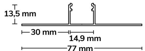
Das Schutzcover wird nach der Montage des Profils in das Alu-Profil zum Schutz eingeklickt. Dadurch, dass es sehr robust ist, hält es dem Druck beim Verspachteln/-putzen oder Streichen stand. Es verhindert, dass Spachtelmasse, Kleber, Dichtmaterial, Silikon oder Farbe in den Innenraum eindringt. Danach wird das Schutzcover abgenommen, gereinigt und ist vielfach wiederverwendbar. Abschließend kann die Abdeckung (PC) in das Profil eingesetzt werden.
