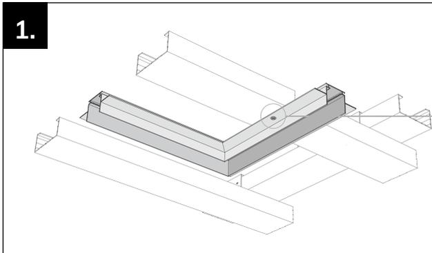
**Schritt 1:** Der Installationskanal wird an den seitlichen Flügeln mit der Unterkonstruktion der Decke verschraubt. Tipp: Die vorgebohrten Löcher etwas versenken, damit die Schrauben bündig mit dem Installationskanal abschließen.
