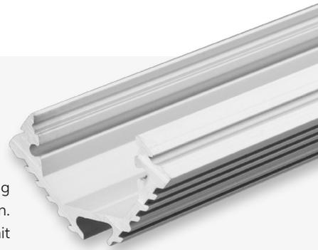
**Kühlmasse: 320 g/m** | Das CORNER12 ist für leistungsstärkere LED Flexbänder konzipiert. Die Riffelung auf der Außenseite vergrößert die Oberfläche des Profils und funktioniert wie wärmeableitende Kühlrippen. In Kombination mit der Kabelschleuse TUNNEL (Art. Nr. [112528](#)) kann das Profil als Hängeleuchte mit Seilabhängung installiert werden. Bei Deckenschrägen werden Gelenk-Gripper verwendet.
