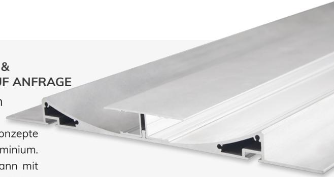
**Kühlmasse: 1753 g/m** | Nachhaltige Design-Leuchte für indirekte Beleuchtungskonzepte im Trockenbau bestehend aus zwei Lichtbauelementen aus hochwertigem Aluminium. Die Grundplatte wird mit den Gipsplatten verspachtelt. Das Lichtbauelement kann mit zwei Flexbändern ausgestattet werden (max. 11 mm Breite). Wartungsfreundliches Stecksystem.
